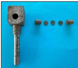
Figura 3. Extracción de las muestras de SPT.
